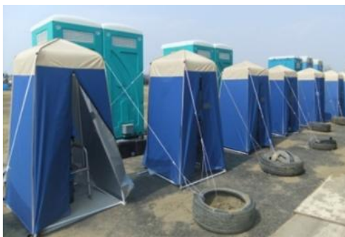
備蓄が容易で、日常使用しているトイレに近い環境を迅速に確保できる「マンホールトイレ」
