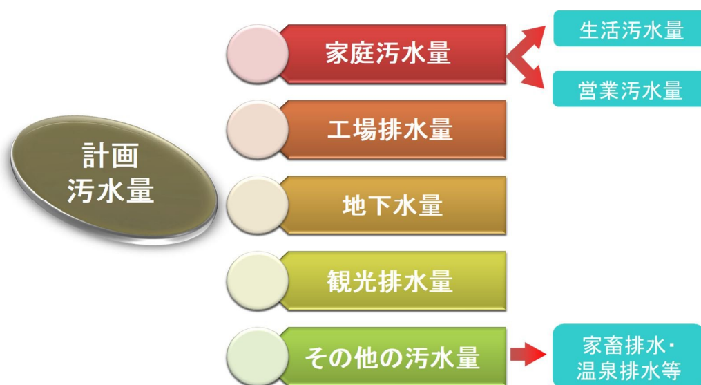
図 3.2.1 計画汚水量の分類イメージ図
