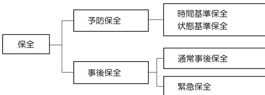
図 「電気設備」「空調設備」等の保全体系
