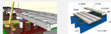
施工・架設計画の迅速化 プレキャスト床版
