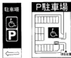
【駐車場の案内標識の例】
